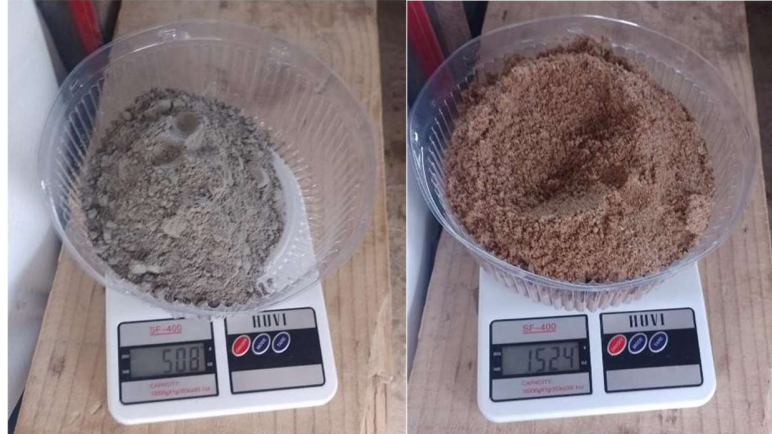
Figura 3 – Processo de pesagem do cimento e do agregado miúdo
