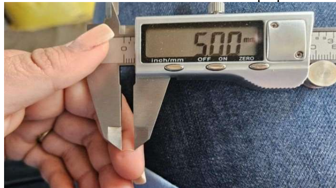
Figura 1 – Processo de medida da fibra com paquímetro digital.
