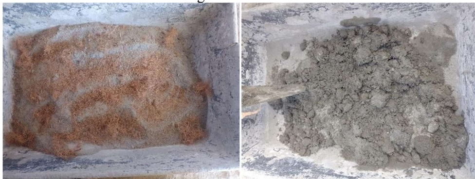
Figura 4 – (a) Processo de adição da fibra na argamassa; (b) Mistura manual da argamassa
