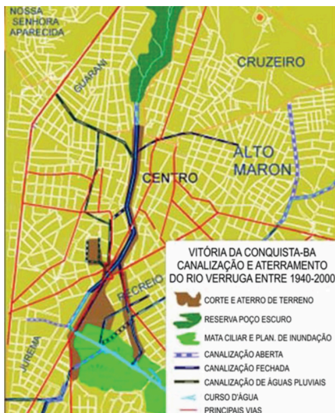
Figura 6 – Canalização e Aterramento do Rio Verruga entre 1940 e 2000
