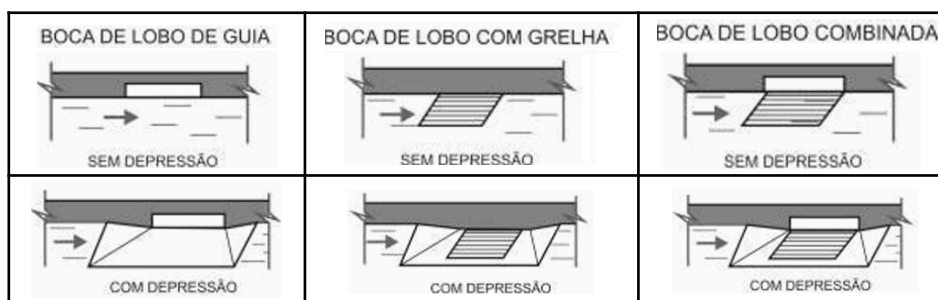
Figura 3 – Tipos de Bocas de Lobo
