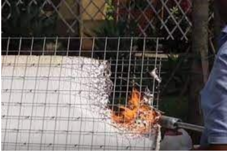
Figura 3 - Teste de fogo em EPS tipo F
