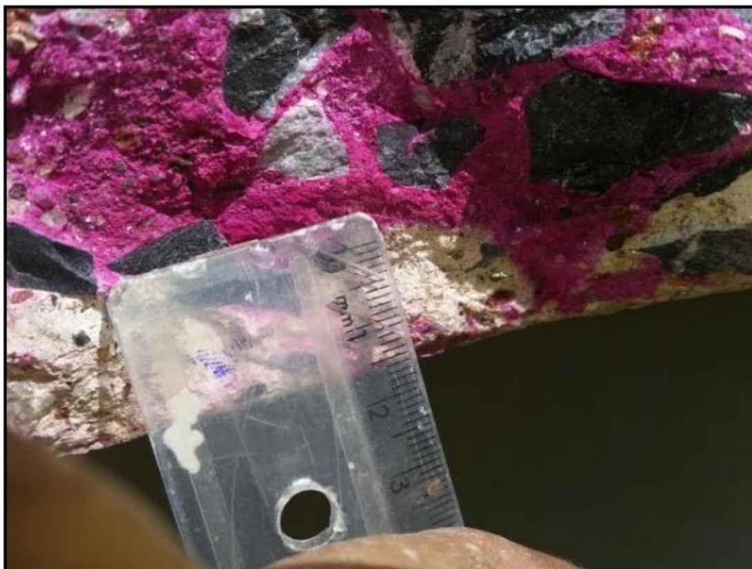
Figura 04: Carbonatação Laje 4 – 1º Piso – Pav. Comando da Organização Militar do Exército em Brasília – DF.
