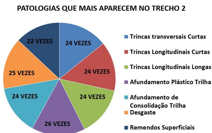
Gráfico 02- Patologias mais freqüentes no segundo trecho de 500 metros.
