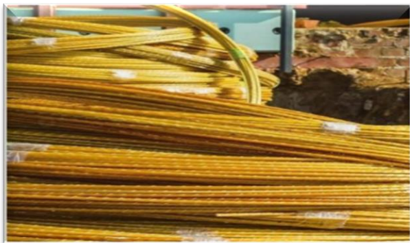
Figura 4 – Perfis de PRFV em cordoalha e Barra reta
