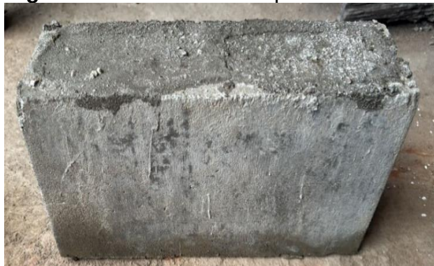
Figura 2 - Amostra sem impermeabilizante.
