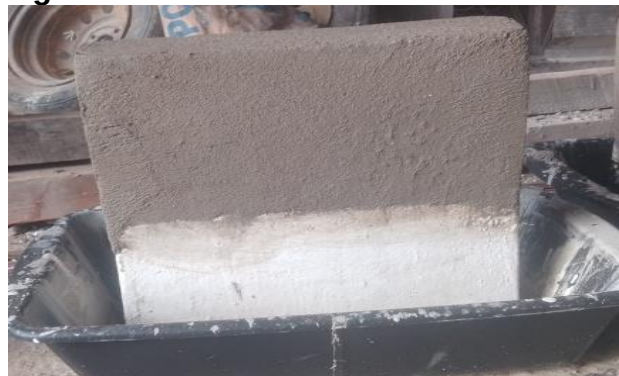
Figura 6 - Alvenaria e reboco na 2ª amostra
