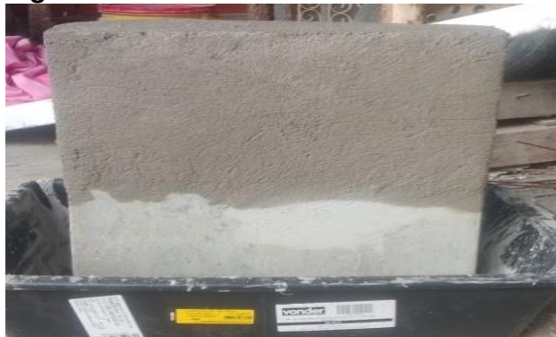
Figura 5 - Alvenaria e reboco na 1ª amostra
